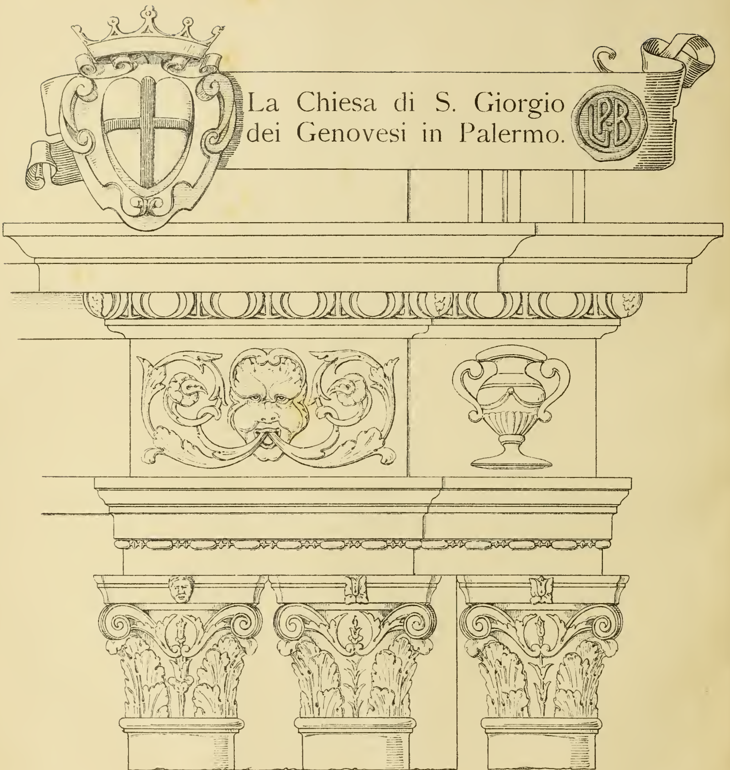
Coronamento dell'ordine superiore interno — 1:10.
